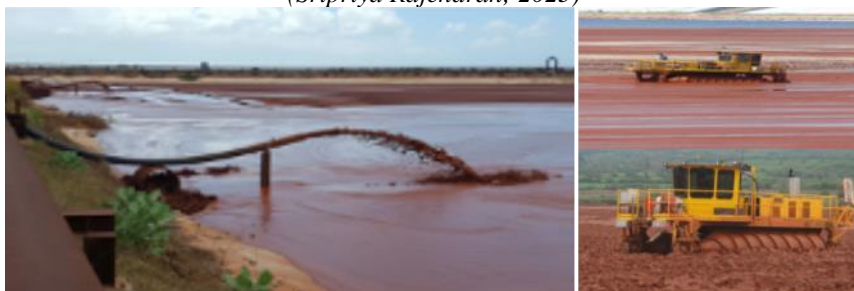
Hình 5. Ảnh đổ thải (trái) và dùng máy Amphirol (phải) để thải bùn đỏ theo phương pháp xếp khô tại nhà máy nhôm ở Jamaica (International Aluminium Institute; 2021)
