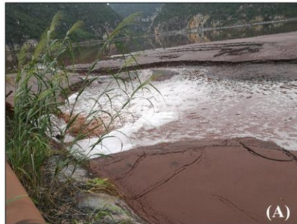
Hình 4. Ảnh bùn đỏ và phương pháp thải ướt tại Bình Quố, tỉnh Quảng Tây, Trung Quốc. (Sripriya Rajendran; 2023)
