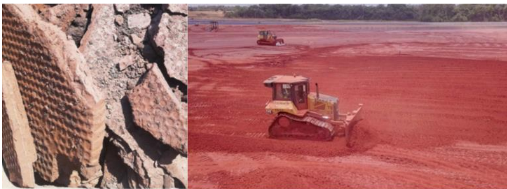
Hình 6. Bã lọc bùn đỏ (trái) và xe ủi (phải) trong phương pháp lưu trữ khô bùn đỏ tại Trung Quốc (International Aluminium Institute; 2021)
