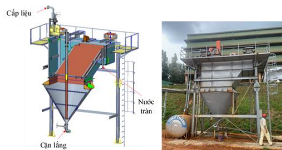
Hình 1. Cấu tạo và ảnh của bể lắng lamella bán công nghiệp
