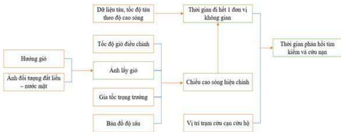
Hình 6. Quy trình xử lý dữ liệu mô hình hóa khoảng cách hiệu dụng trong tìm kiếm, cứu nạn trên biển
