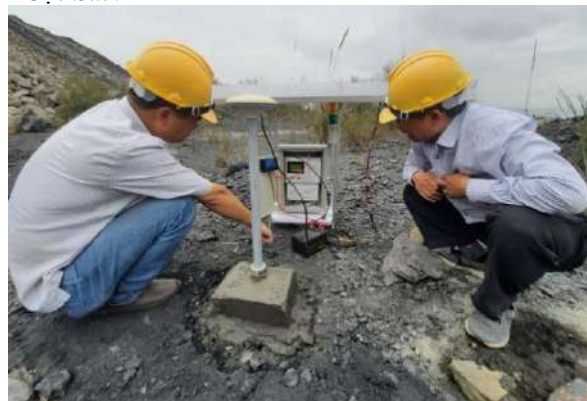
Hình 7. Trạm quan trắc trượt lở bờ mỏ đã được lắp đặt
