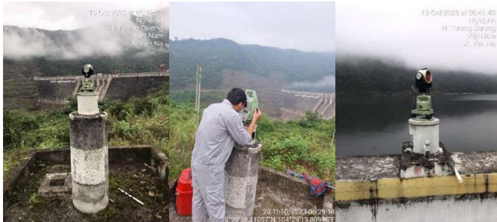
Hình 4. Đo lưới quan trắc đập thủy điện Bản Vẽ (ảnh Nguyễn Quang Hà)
