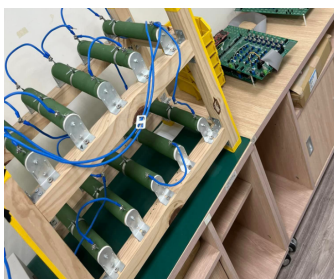
a) Tải giả điện trở dây quấn công suất lớn trong phòng thí nghiệm
