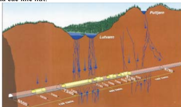
Hình 1. Xâm nhập của nước mặt vào công trình ngầm qua các khe nứt [7]
