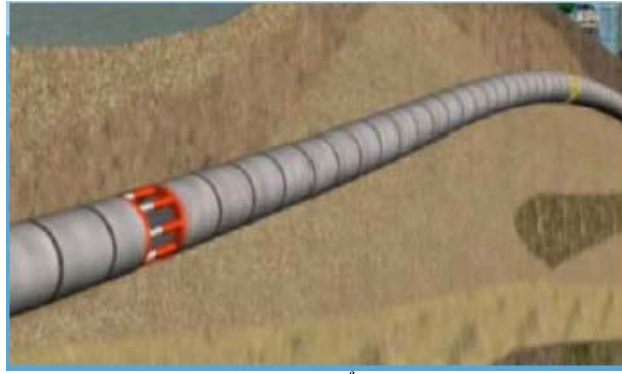
Hình 6. Trạm kích đẩy trung gian [3]
