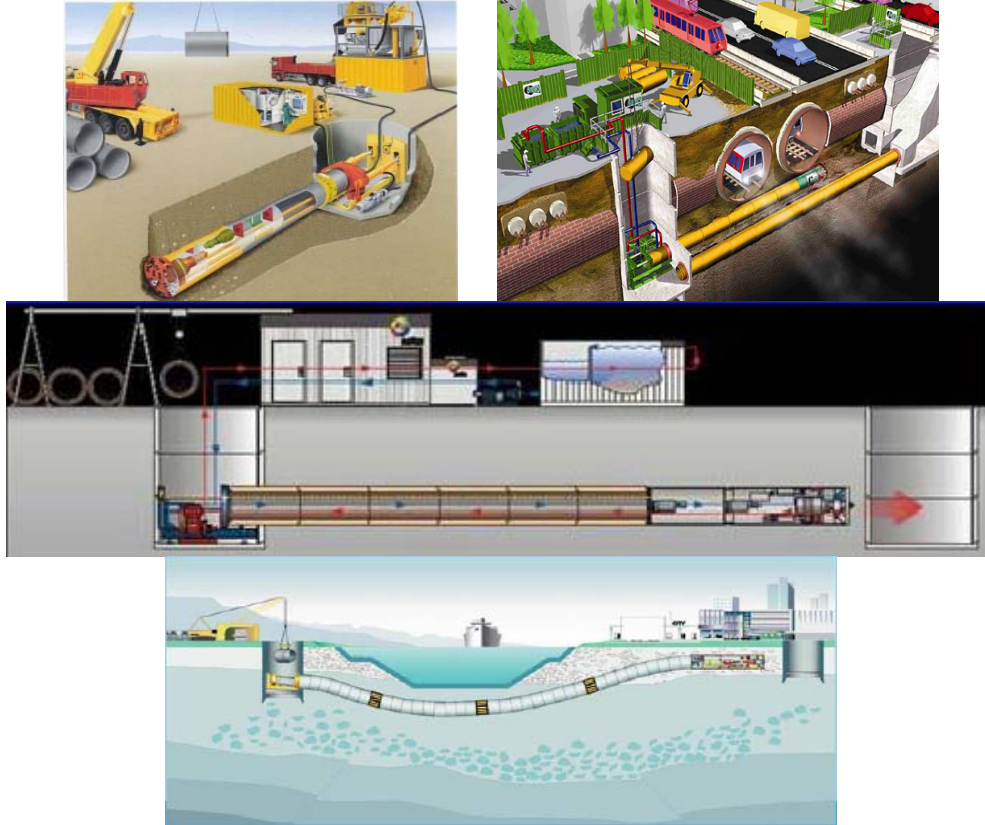
Hình 4. Khai đào đường hầm tiết diện nhỏ bằng khoan hầm tiết diện nhỏ hoặc khiên đào mini tiết diện nhỏ [3]
