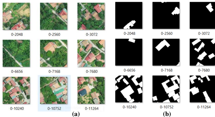
Hình 3. Các tiles được chia nhỏ từ ảnh UAV và các mặt nạ “mask” tương ứng.
