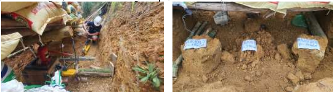
Hình 5. Tiến hành thí nghiệm và mô tả mẫu đất sau thí nghiệm – dự án Wedo-Wegood Hoà Bình Farm Trình tự tiến hành thí nghiệm cắt khối lớn và xử lý các kết quả thí nghiệm được trình bày ở Hình 6.
