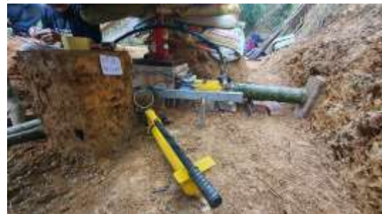
Hình 4. Lắp đặt thiết bị thí nghiệm cắt khối lớn – dự án Wedo-Wegood Hoà Bình Farm
