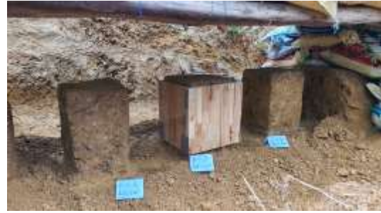
Hình 2. Tạo mặt bằng và mẫu thí nghiệm – dự án Wedo-Wegood Hoà Bình Farm
