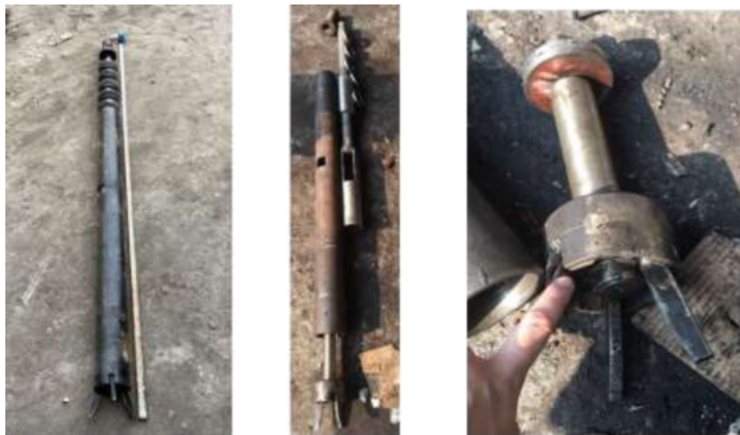
Hình 3. Hình ảnh bộ dụng cụ được gia công theo thiết kế cho cấp đường kính \phi 112
