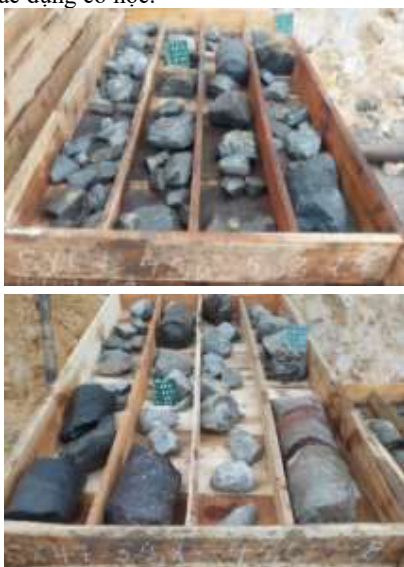
Hình 5. Địa tầng đất đá nứt nẻ mạnh dễ gây mất nước và sự cố (trái) và kết cấu tại lỗ khoan SX47 (phải)
