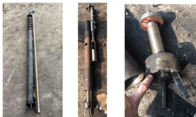
Hình 3. Sản phẩm chế tạo bộ dụng cụ nút trám xi măng cấp đường kính \Phi 112
