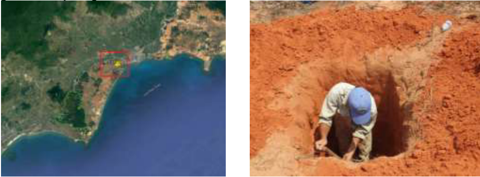
Hình 1. Vị trí và phương pháp lấy mẫu thí nghiệm xác định hệ số thấm sử dụng máng thấm trong phòng thí nghiệm a. Xác định theo phương pháp cột nước không đổi, thường áp dụng cho đất thấm tốt
