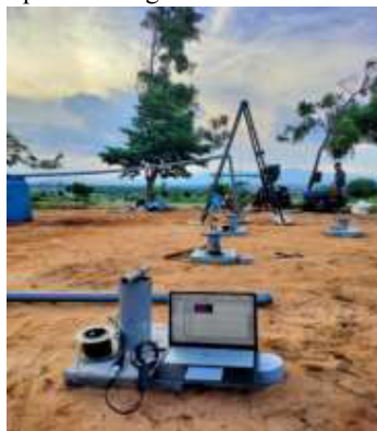
Hình 2. Lắp đặt các đầu đo tự động mực nước và nồng độ muối (độ dẫn điện) có sử dụng cáp nối với máy tính và cập nhật số liệu theo thời gian thực bằng phần mềm Solints Data Logger
