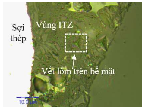
Hình 3. Bề mặt mẫu thí nghiệm tại vùng ITZ sau khi thí nghiệm NI
