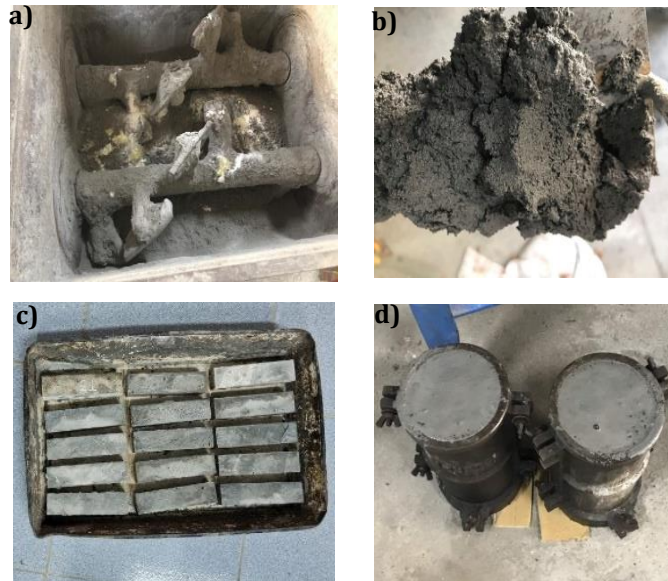
Hình 4. Công tác chế tạo mẫu bê tông cốt sợi tự nhiên. (a) Máy trộn bê tông, (b) Bê tông hạt mịn sau khi trộn, (c) Mẫu 40 x 40 x 160 mm, (d) Mẫu hình trụ.
