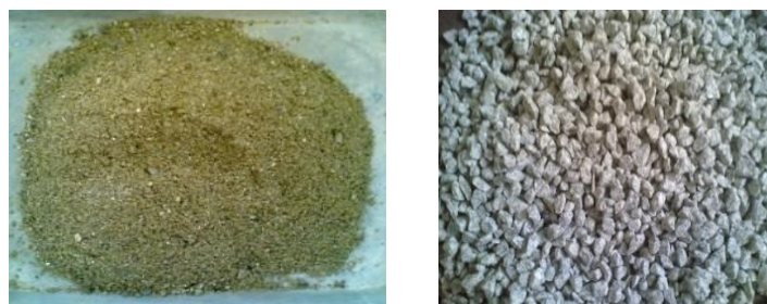
(a)- Cát vàng sông Lô (b)- Đá dăm 5-10 mm Hình 2. Cốt liệu sử dụng trong nghiên cứu
