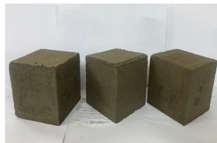
Hình 5. Mẫu bê tông thí nghiệm hình lập phương kích thước 100x100x100mm
