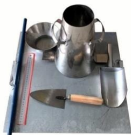
Hình 3. Bộ côn hình nón cụt tiêu chuẩn kích thước 10x20x30cm
