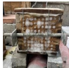
Hình 2. Quá trình giải thoát pha khí và pha lỏng từ hỗn hợp bê tông
