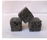
Hình 2. Các viên mẫu bê tông hình lập phương 30×30×30 mm
