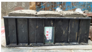
Hình 1. Độ nở của hỗn hợp bê tông nhẹ sau khi đổ khuôn
