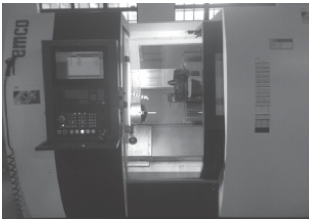
Hình 3. Hình ảnh quá trình tiện mẫu trên máy CNC Emco Turn E65.
