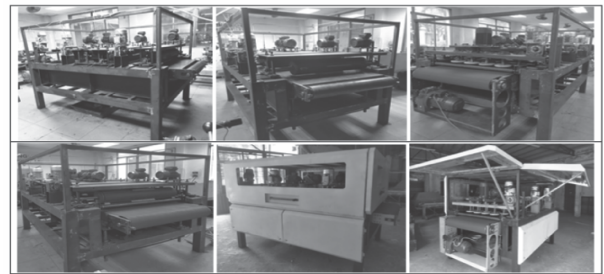
Hình 5. Tổng thể máy đánh bóng sau khi chế tạo, lắp ráp, sơn hoàn thiện
