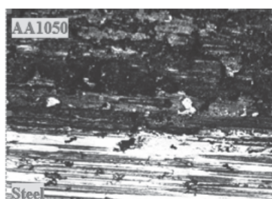
Hình 3. Tổ chức tế vi (x50) đường liên kết hàn nổ nhôm-thép khi với H = 30 mm: a – Khi h = 3 mm;
