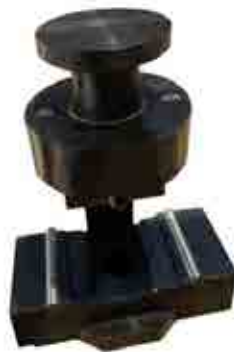
Hình 2. Hộp thí nghiệm uốn.
