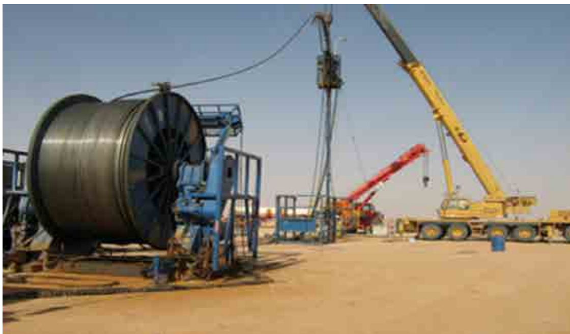
Hình 9: Thiết bị coil tubing bơm rửa và ép xylene [7].
