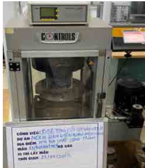
Hình 1: Quá trình nén mẫu bê tông.
