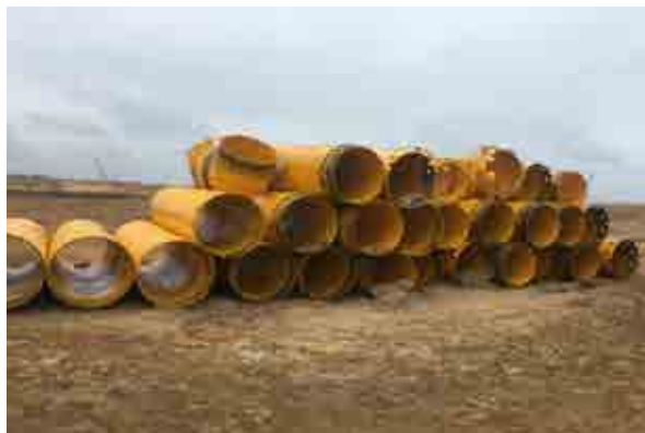
Hình 2. Cấu tạo và hình ảnh ống chống (casing) 2 lớp.
