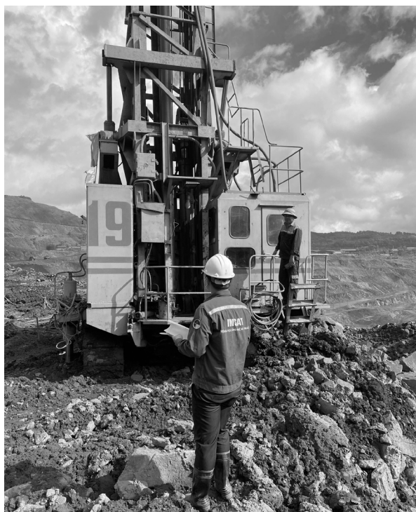
Hình 4. Theo dõi công tác khoan tại bãi nổ thử nghiệm
