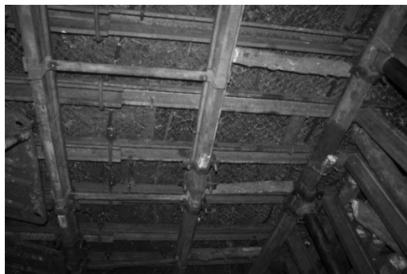
Hình 3. Giải pháp khâu lẫn cáp và trải lưới thép tạo diện thu hồi giàn chống
