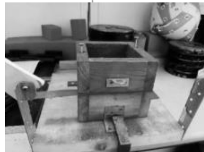
Hình 3. Thiết bị xác định lực dính kết của than N – lực nén; T – lực cắt; A – Diện tích mặt cắt ngang của mẫu
