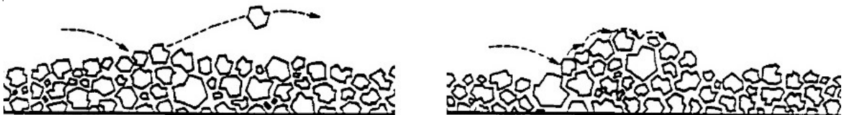
Hình 1. Bong bật mặt đường do lực tác động của hoạt động vận tải
