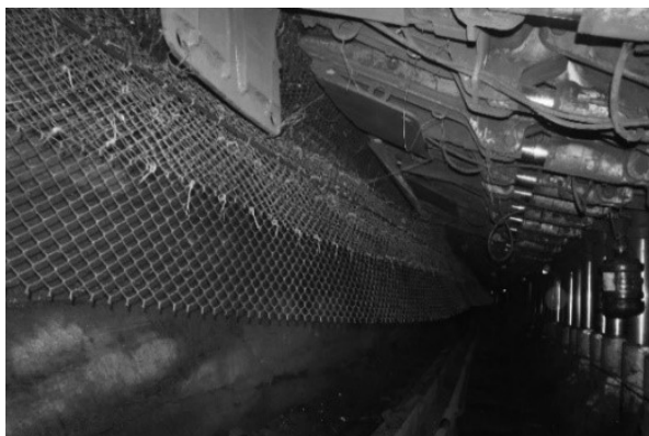
Hình 3. Giải pháp khâu lẫn cáp và trải lưới thép tạo diện thu hồi giàn chống
