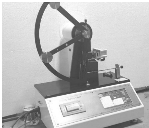
Hình 2. Thiết bị kiểm tra độ bền xé
