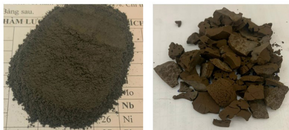
Hình 7. Hình ảnh bùn cặn nặng và bùn nhẹ sau khi phân tách
