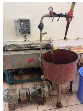
Hình 6. Thiết bị cyclon thí nghiệm tách bùn cặn nặng
