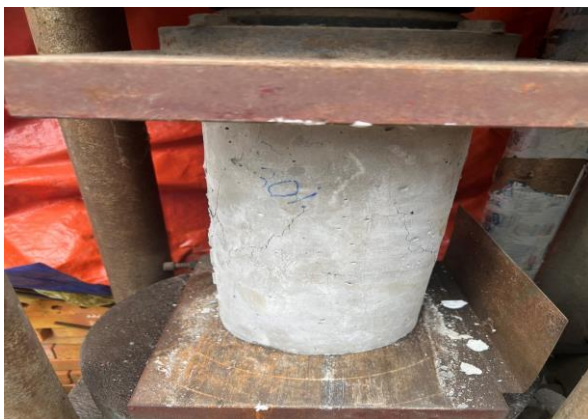
Hình 3. Mẫu bê tông lấp đầy 30% tro bay sau khi nén tại LAS-XD 891 trực thuộc Công ty TNHH Tư Vấn Xây Dựng Cửu Long E&C
