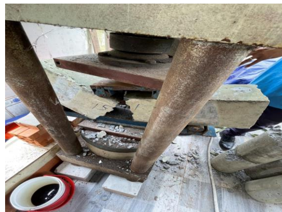
Hình 4. Thí nghiệm độ bền kéo của mẫu quá thí nghiệm uốn tại LAS-XD 891
