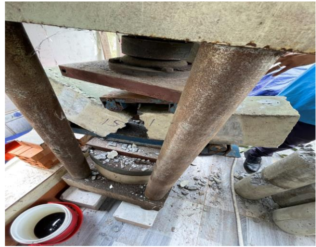
Hình 5. Thí nghiệm độ bền kéo của mẫu quá thí nghiệm uốn tại LAS-XD 891
