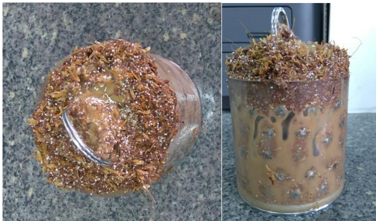
Hình 11. Mô hình hóa bằng các viên bi thép có đường kính 4,39 mm trong ống bọc ngoài sử dụng vật liệu bít nhét như hàm lượng xơ dừa và calcium carbonate.
