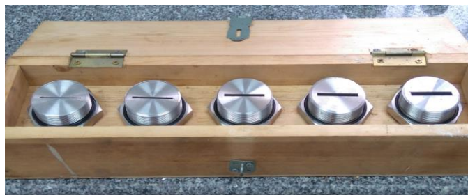
Hình 7. Mô hình hóa các vết nứt với chiều rộng vết nứt từ 1 đến 5 mm.
