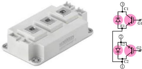
Hình 1. Hình dạng bên ngoài và sơ đồ nối dây của IGBT SKM600GB12E4
