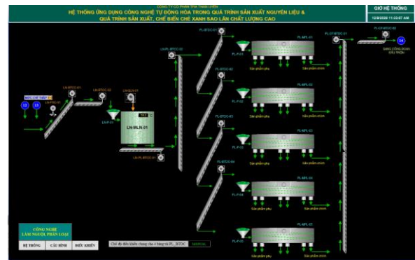
Hình 10. Màn hình giám sát điều khiển công đoạn làm nguội và phân loại chèn
