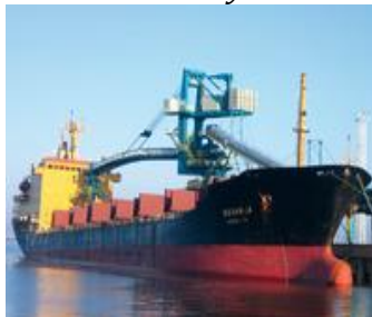
Hình 5. Máy rót tải đứng cố định, năng suất rót xỉ than 330 t/h, dùng ở cảng Hà Lan
