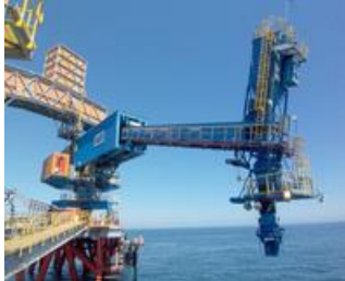
Hình 3 Máy chất tải đứng cố định, năng suất chất tải 1000 t/h, được sử dụng ở Cảng Chile
