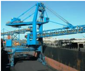
Hình 4 Máy chất tải di chuyển, năng suất chất tải 3000 t/h, được sử dụng ở Cảng Mozambique
