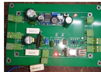
Hình 5. Kết quả thử nghiệm khi điện trở cách điện R_{cd} \geq 22\text{k}\Omega
