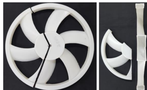
Hình 2. Mặt cắt của quạt (quạt rỗng ở giữa)
