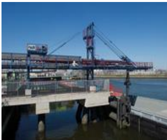
Hình 5. Máy rót tải đứng cố định, năng suất rót xỉ than 330 t/h, dùng ở cảng Hà Lan
