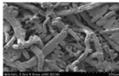
Hình 3.2. Hình ảnh SEM của mẫu xúc tác Ag sau khi hoàn nguyên
