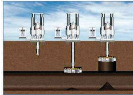
Hình 5. Mô hình công nghệ khoan doa ngược lên trên khi đào lò dốc (máy khoan ở mức thấp)
