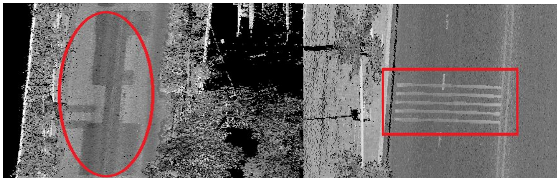
Hình 9. Đám mây điểm (colour by intensity) và các vị trí hư hỏng, vị trí ký hiệu
