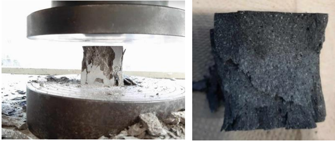
Hình 3. Thí nghiệm kiểm tra cường độ nén.
