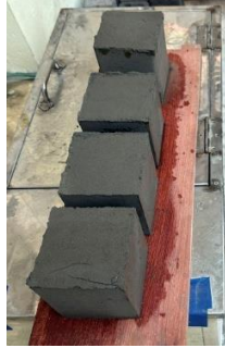
Hình 6. Mẫu bê tông thí nghiệm hình lập phương kích thước 10x10x10cm
