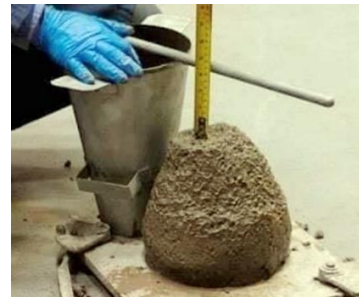
Hình 4. Xác định độ sụt của hỗn hợp bê tông
