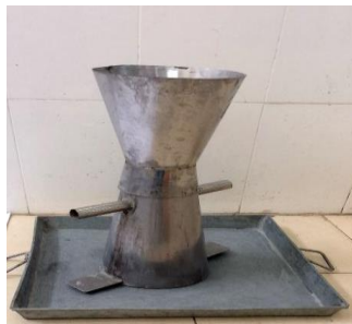
Hình 3. Bộ côn hình nón cụt tiêu chuẩn kích thước 10x20x30cm
