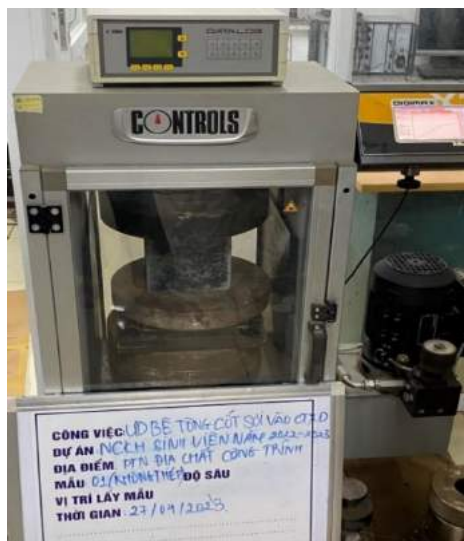
Hình 1: Quá trình nén mẫu bê tông.
