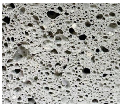
Hình 11. Cấu trúc và phân bố lỗ rỗng không dị hướng trong mẫu bê tông nhẹ đối chứng
