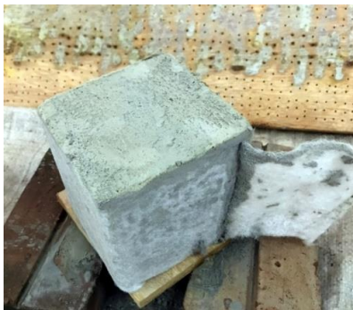
Hình 7. Mẫu bê tông bọt-khí định hướng hình lập phương kích thước 100x100x100 mm
