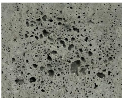
Hình 10. Cấu trúc và sự phân bố lỗ rỗng tổ ong dị hướng trong mẫu bê tông nhẹ dị hướng
