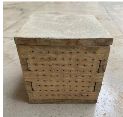
Hình 4. Các tấm thành khuôn được đục lỗ để thoát pha khí và pha lỏng
