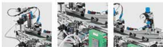
Hình 1.1. Mô hình phân loại phôi nhập khẩu của hãng Festo
