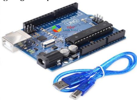
Hình 1. Bo mạch Arduino và cáp giao tiếp USB Một số thông số kỹ thuật của Arduino UNO R3:
