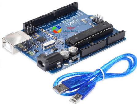
Hình 1. Bo mạch Arduino và cáp giao tiếp USB Một số thông số kỹ thuật cơ bản của Arduino UNO R3:
