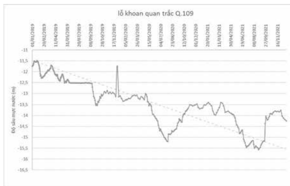
Hình 3. Diễn biến mực nước TCN Neogen (n) tại lỗ khoan quan trắc Q109 từ 2019 đến 2021
