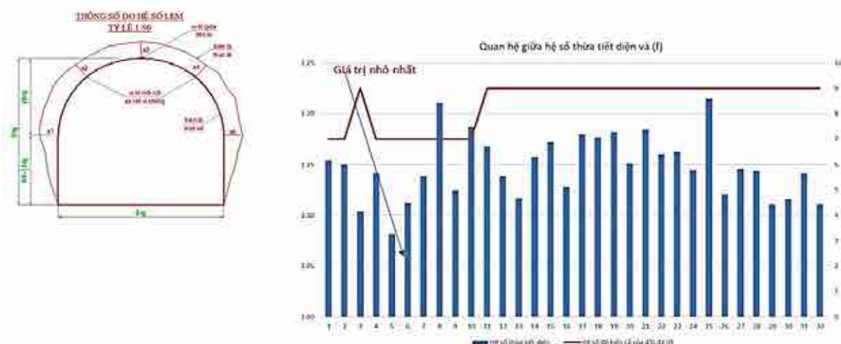
Hình 10. Quan hệ giữa hệ số thừa tiết diện và hệ số độ kiên cố đất đá f tại lò dọc vỉa đá mức +200 vỉa 6 (khu Bình Minh - Công ty than Mạo Khê - TKV).
