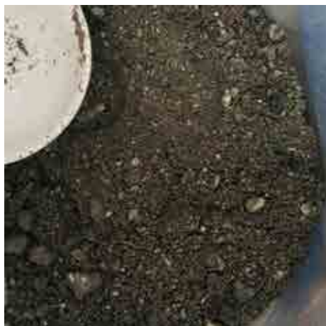
Hình 2. Mẫu tro đáy dùng cho thí nghiệm xác định thành phần hạt.
