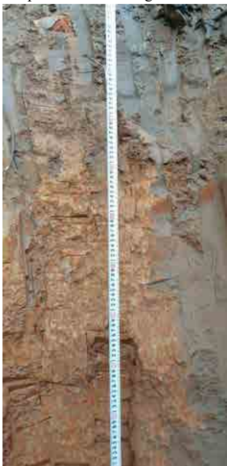
Hình 4. Quan sát đặc điểm địa chất và cột địa tầng địa chất tại khu vực đổ nước thí nghiệm ở Bắc Ninh.
