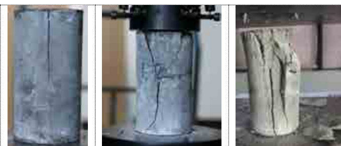
Hình 3. Hình ảnh mẫu khi thí nghiệm nén.
