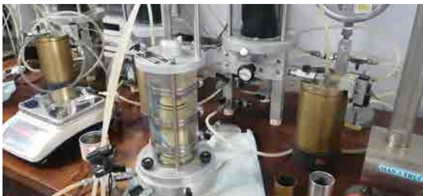
Hình 2. Thí nghiệm thấm trên mẫu ba trục.
