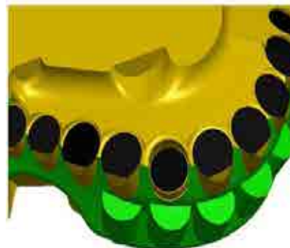
Hình 5. Mặt cắt ngang của cánh chèo FuseTek.
