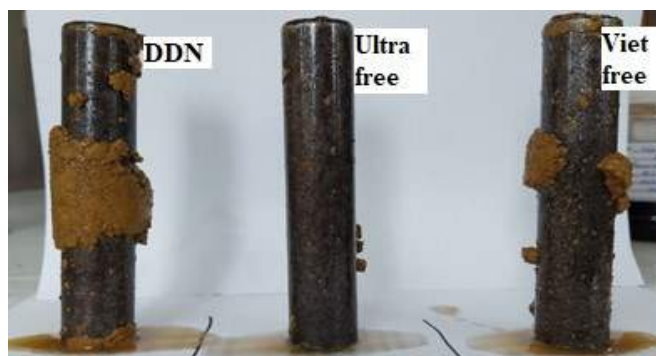
Hình 5. Thí nghiệm Ultrafree, Vietfree, Klafree 3% trong dung dịch KGAC Plus M1.
