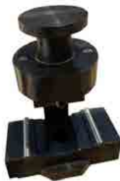
Hình 2. Hộp thí nghiệm uốn.
