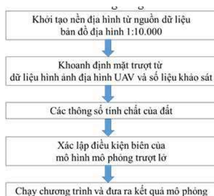
Hình 4. Sơ đồ phân tích trượt lở quy mô lớn bằng mô hình LS-Rapid.
