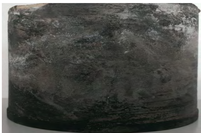
Рисунок 2. Фотография образца цементного камня на основе без добавочного ПЦТ I-G после термического воздействия
