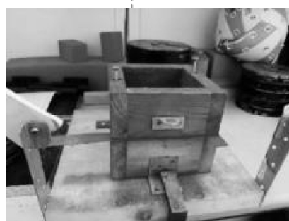
Hình 3. Thiết bị xác định lực dính kết của than N – lực nén; T – lực cắt; A – Diện tích mặt cắt ngang của mẫu
