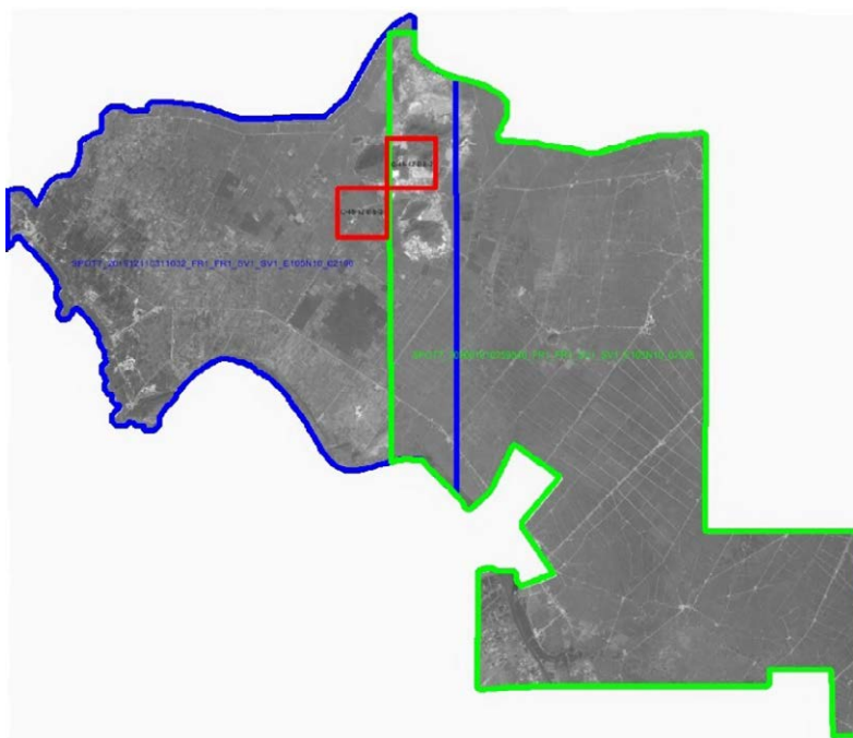
Hình 1: Sơ đồ 02 cặp ảnh vệ tinh SPOT 7 lập thể và khu vực thực nghiệm (02 mảnh bản đồ tỷ lệ 1:10.000 - các ô màu đỏ)
