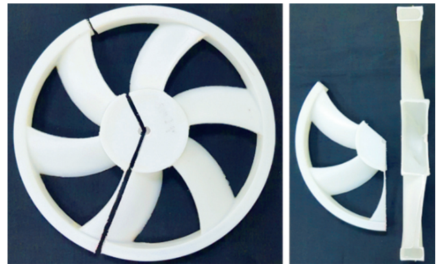
H.2. Mặt cắt của quạt chế tạo (quạt rỗng ở giữa)
