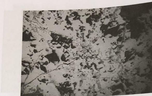
Chalcozin, covelin dạng mạng mạch (Mẫu KTL.769; độ phóng đại 10x): Chz-Chalcozin, Cv-Covelin, Bo-Bornit.
