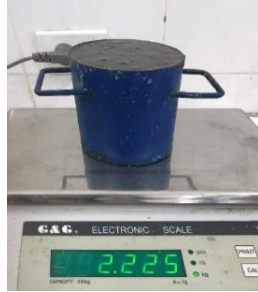
Hình 6. Xác định khối lượng thể tích của hỗn hợp bê tông hạt mịn.
