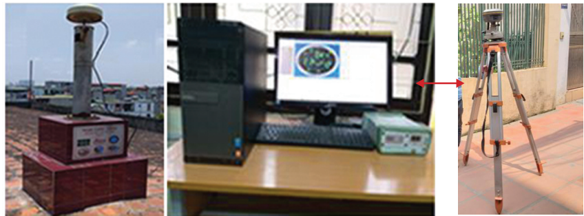
a) Trạm CORS-N001
