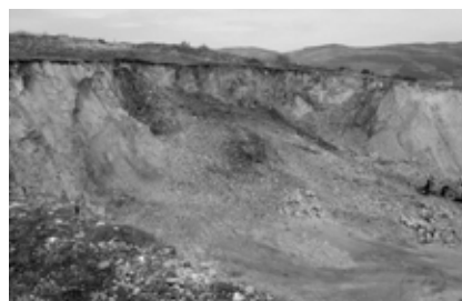
b, Kết quả nổ hỗn hợp nhũ tương tốc độ nổ cao tại mỏ Zelenikivec, Ukraina [7]
