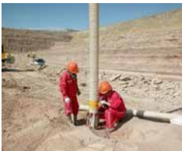
a, Nạp thuốc nổ Anfo trong ống PVC tại mỏ Zhundong, Trung Quốc [10]
