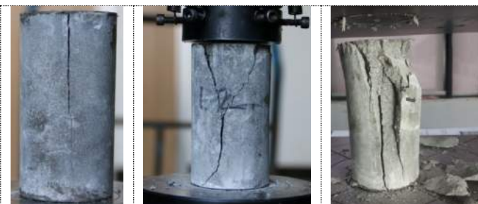
Hình 3. Hình ảnh mẫu khi thí nghiệm nén.
