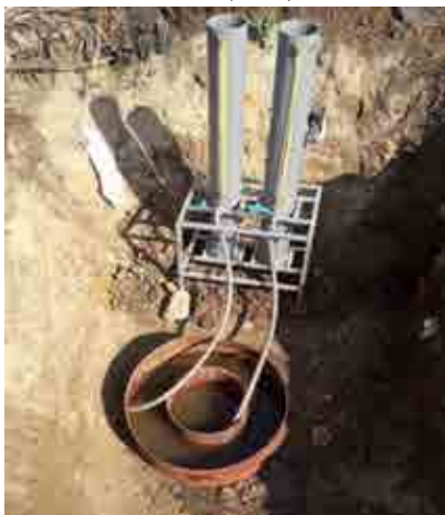
Hình 2. Thí nghiệm đổ nước hố đào trong vùng nghiên cứu.
