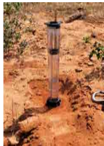
Hình 3. Thí nghiệm đo tốc độ ngấm sử dụng đĩa sức căng trong vùng nghiên cứu.
