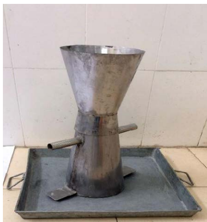
Hình 5: Bộ côn hình nón cụt tiêu chuẩn có kích thước 10 \times 20 \times 30 \text{ cm}
