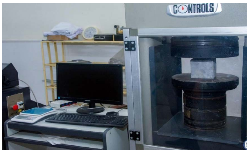
Hình 7: Hệ thống máy nén uốn tự động ADVANTEST 9
