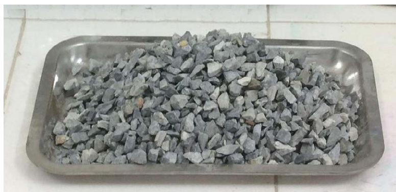
Hình 2: Cốt liệu lớn - đá dăm 5-10 mm
