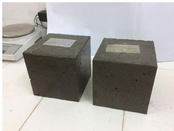
Hình 6: Mẫu bê tông thí nghiệm hình lập phương cạnh 15 cm
