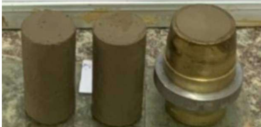
Hình 1. Mẫu gia cố đất - xi măng tỷ lệ 180 kg/m 3 thí nghiệm thấm.
