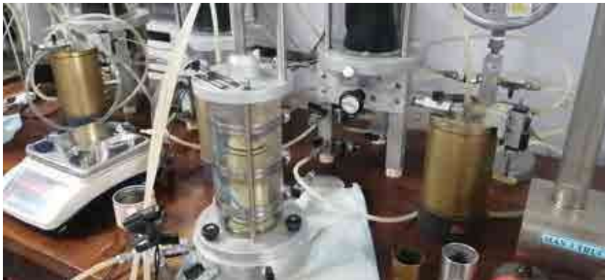
Hình 2. Thí nghiệm thấm trên mẫu ba trục.
