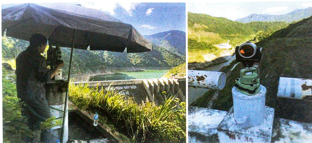
Hình 4. Đo góc cạnh bằng máy toàn đạc điện tử Leica (ảnh EVN-PECCI)
