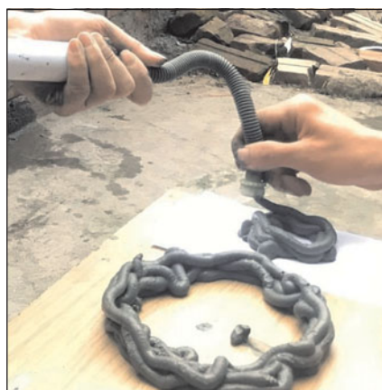
Рис. 5. Тестовый процесс для оценки пригодности бетонной смеси для печати
