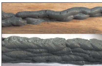
Рис. 6. Непрерывные экструдированные бетонные ленты из мелкозернистой бетонной смеси состава I3D-01
